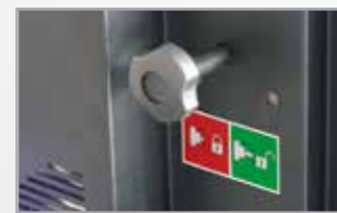
Mechaniczna blokada wagi butli z czynnikiem.
